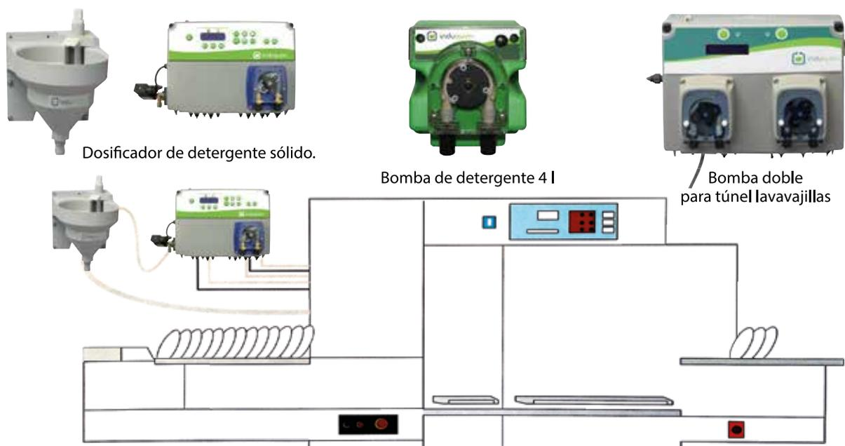
Esquema de instalación de dosificación Bimat Solid en el túnel de lavado de vajillas.
